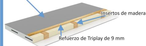
Piso reforzado de lamina galvanizada antiderrapante y reforzada con triplay de 9 mm en contrachapado marino de 9 mm
